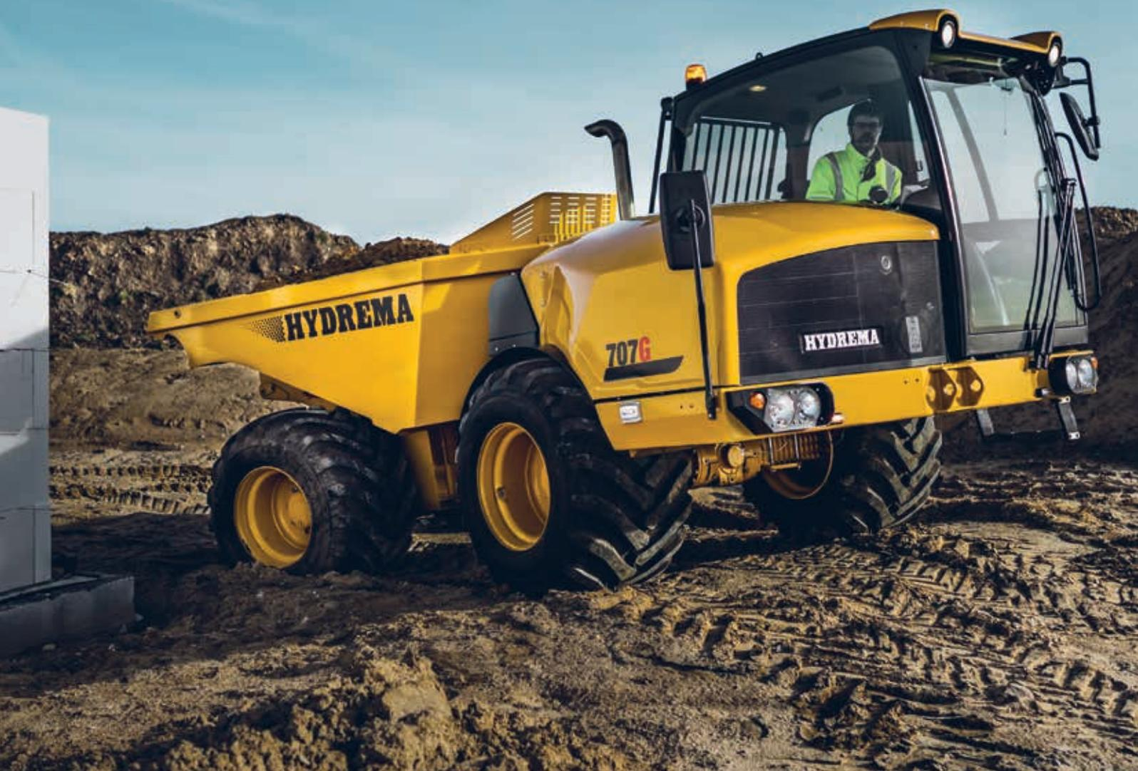
Un tombereau articulé compact. Doté des éléments de sécurité d'un gros tombereau. Avec cabine orientée vers l'avant, direction articulée et transmission hydrostatique.
